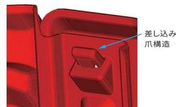
止水板の連結には本体同士の差込爪構造で行います。組付け易さ及び強度も十分考慮された設計で、板同士が重なりあう部分のパッキンが潰され止水性を高めます。
