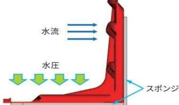
潰れると止水性が高まる素材を使用。水圧によって底面や背面のパッキンが潰れて高い止水性能が得られます。(設置時は密閉されるよう考慮が必要です。)
